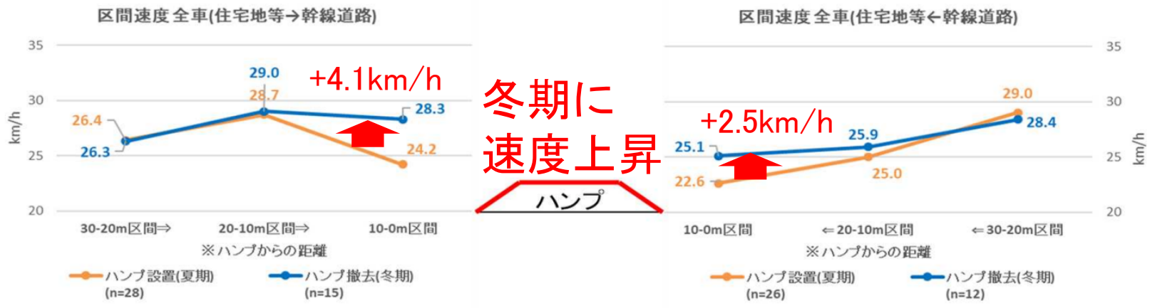
図8 ハンプ前後の自由走行速度(冬期にハンプを一時撤去している地域)
