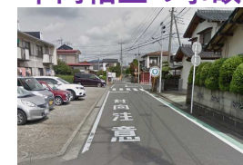
「対向注意」路面標示
